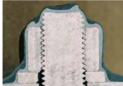
カップ塗装後のナット部切断による塗料の付き廻り状態の確認写真
